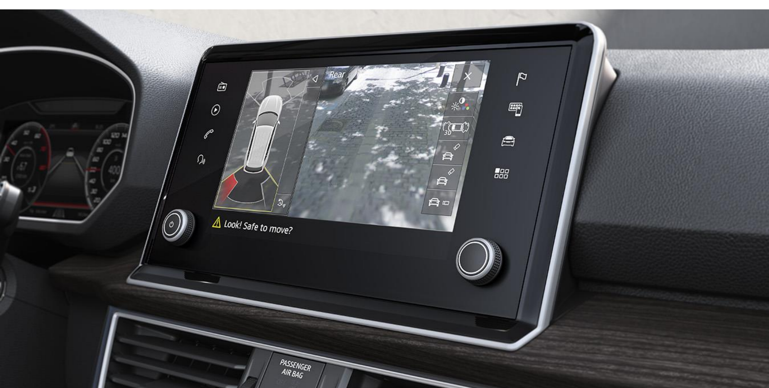
System kamer 360 z widokiem z góry
