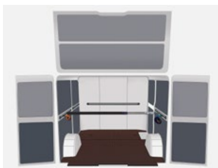
Wyłożenie podłogi przestrzeni ładunkowej płytą ze sklejki 9 mm (antypoślizgowa), panele ścian bocznych polipropyłanowe, panele dolne drzwi tylnych
