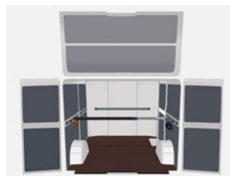
Wyłożenie podłogi przestrzeni ładunkowej płytą ze sklejki 9 mm (antypoślizgowa), panele ścian bocznych polipropyłanowe, panele dolne i górne drzwi tylnych
