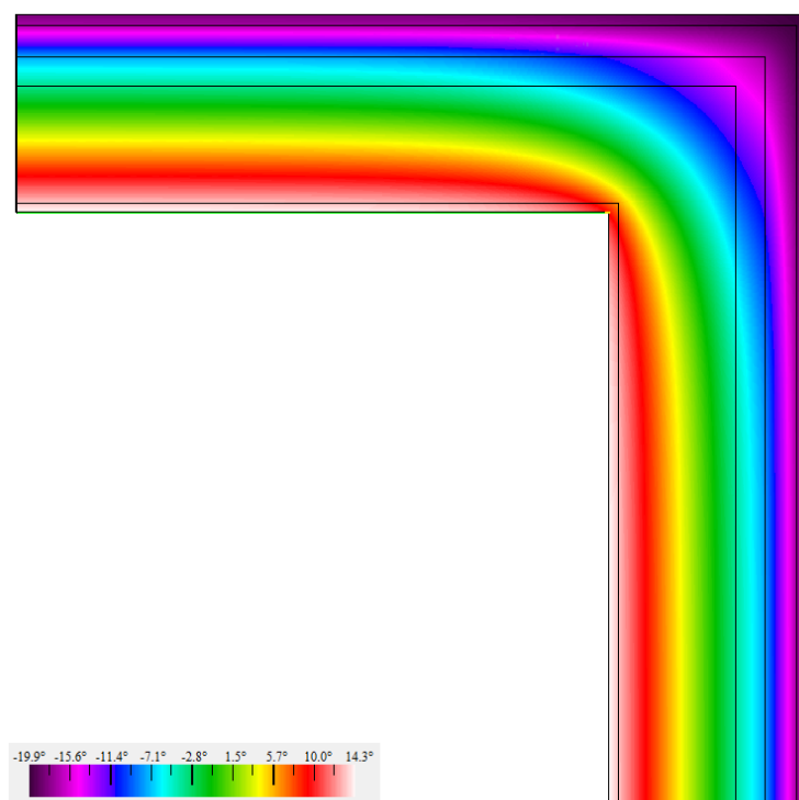
Rysunek 2.3. Termogram - detal naroża ściany zewnętrznej bez ocieplenia
