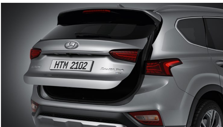
Inteligentny system otwierania bagażnika (bezdotykowe otwieranie klapy)
