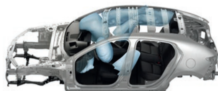
Przednie i boczne poduszki powietrzne + kurtyny powietrzne + poduszka kolanowa dla kierowcy
