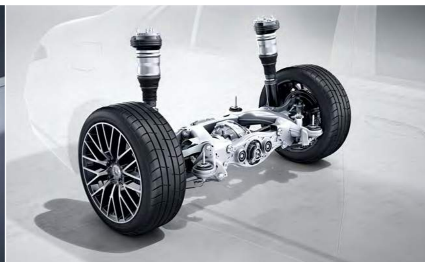
201 - skrętna tylna oś z kątem skrętu 4,5°
